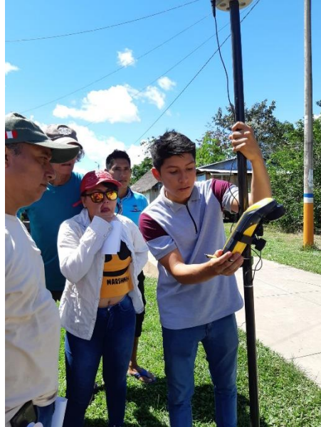
Figura 07. Ander Dávila haciendo la demostración del uso del GPS Trimble Geo7X para el marcado de los puntos de control.
